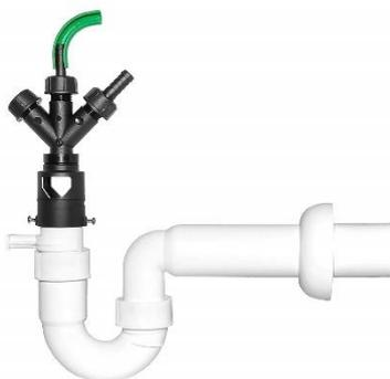
Achtung, nicht mit Schlauchtülle anschließen! Rückstaugefahr. Muss der Abflussschlauch vertikal zu einem höher gelegenen Abfluss geführt werden, unbedingt eine Rückschlagklappe einbauen. Die Anlage kann das Abwasser bis ca. 200 cm über dem Steuerventil drücken. Bitte darauf zu achten, dass der Abwasserschlauch direkt auf die Abflusshöhe verlegt wird und dann mit stetigem Gefälle das Regenerierwasser abfließen kann.
