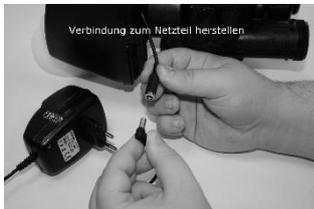
Verbinden Sie das Stromkabel auf der Rückseite des Steuerkopfes mit dem Netzteil und stecken Sie das Netzteil in die Steckdose.
